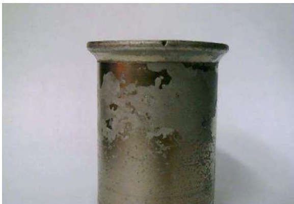
Рисунок 1 - Бракованное ПКХП на силумине
