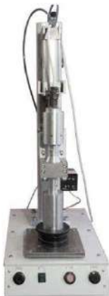
Оборудование для сварки рабочих колес погружных насосов
