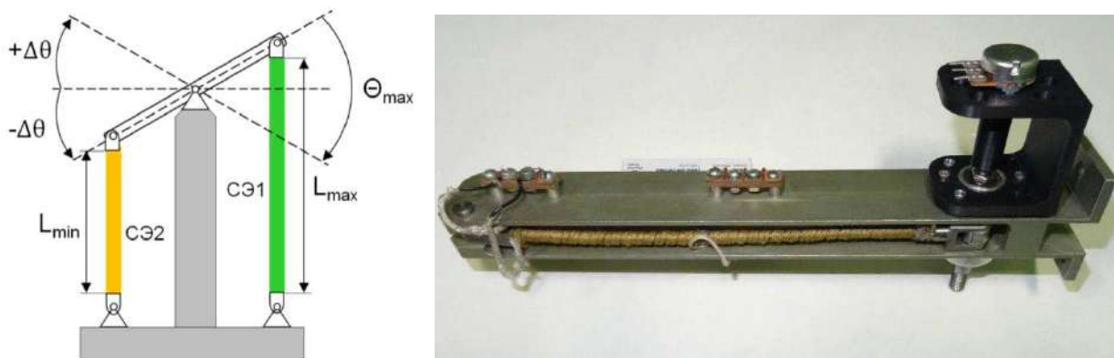
Рисунок 2 - Структурная схема (а) и макетный образец (б) циклического двигателя.
