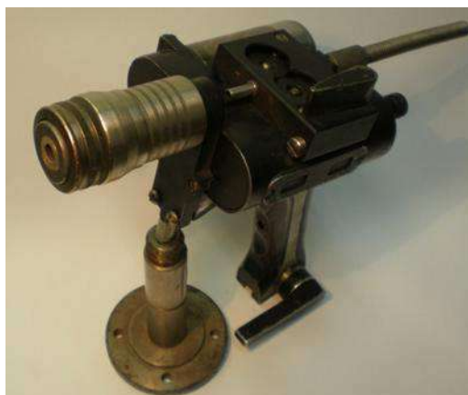
Рисунок 5 - Термораспылитель установки ТЕРКО-2
