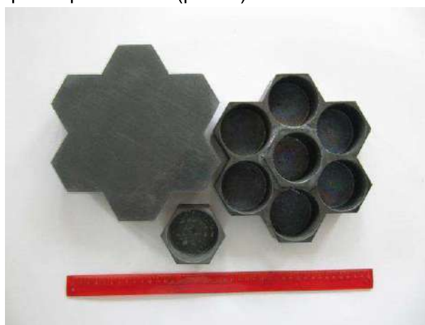
Рисунок 1 – Сборная конструкция подложки зеркала и отдельный шестигранный элемент подложки
