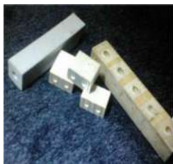
а б в Рисунок 4 - Варианты реализации ППФ из керамики на основе системы x\text{LaAlO}_3-(1-x)\text{CaTiO}_3 : а – полосковые фильтры; б – на диэлектрических резонаторах; в – на двухрезонаторных моноблоках.
