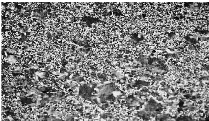
Рисунок 1 – Микроструктура стали 40X после восьми циклов ТЦО
