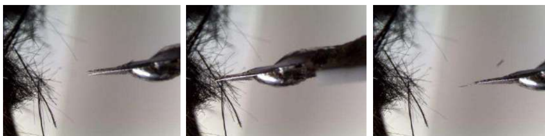
Рисунок 4 - Процесс манипулирования филаментом графитовой нити
