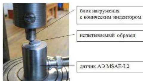
Рисунок 3 - Внешний вид нагружающего устройства акустической установки
