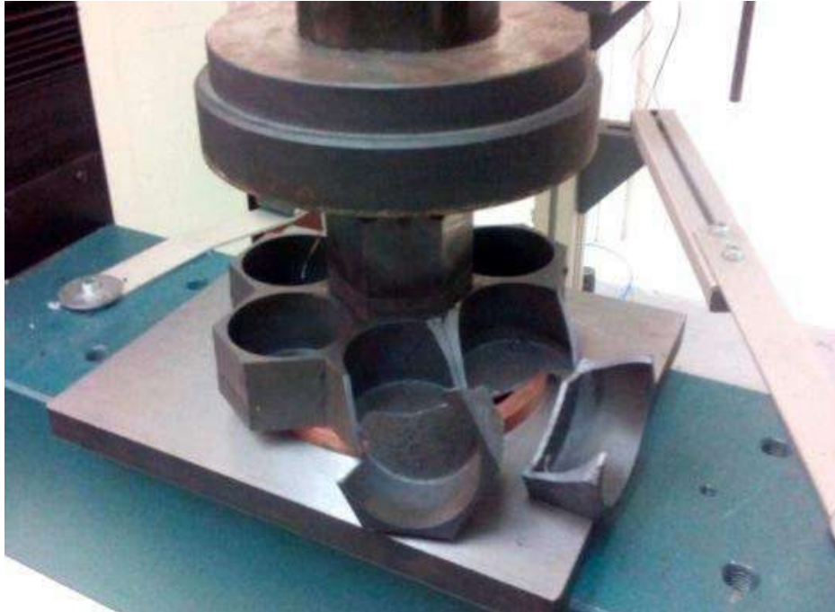
Рисунок 2 – Сборная конструкция подложки зеркала из шестигранных карбидкремниевых элементов после нагружения
