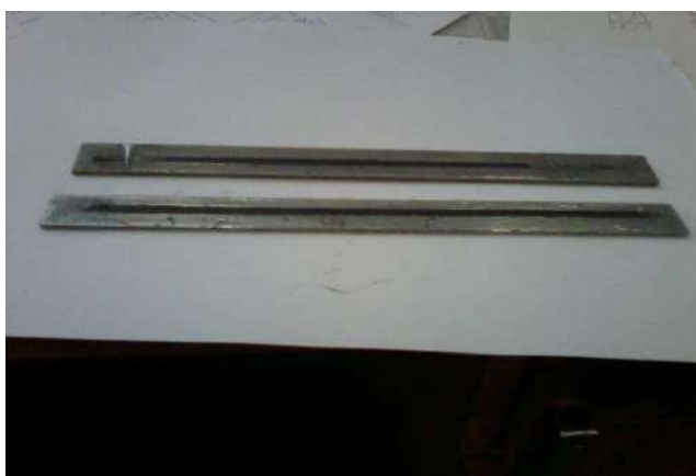
Рисунок 2 - Окончательный вид пластины с пленочным нагревательным элементом
