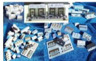
а б в Рисунок 4 - Варианты реализации ППФ из керамики на основе системы x\text{LaAlO}_3-(1-x)\text{CaTiO}_3 : а – полосковые фильтры; б – на диэлектрических резонаторах; в – на двухрезонаторных моноблоках.
