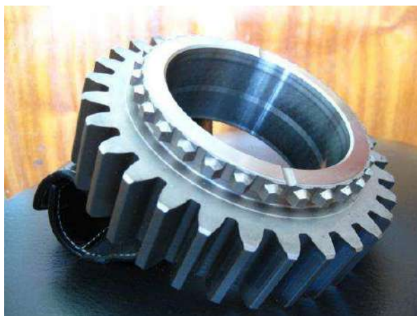
Рисунок 2 – Шестерня опытно-промышленной стали после стендовых испытаний
